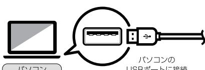
※本製品は電池残量が0%（充電ケースのLEDが消灯状態）になった場合、その状態より復帰するのに0.7Aの電流が必要となります。ただし、一部PCではそのPCが所有しているUSBポートの供給電流が0.5Aの物が存在しています。そのようなUSBポートを使用した場合、電池残量0%から復帰できませんので、その場合はAC/USBの変換アダプター（別売）をご使用ください。5Vより上の出力がある充電器はご使用にならないでください。商品破損、火災の原因になる可能性があります。
